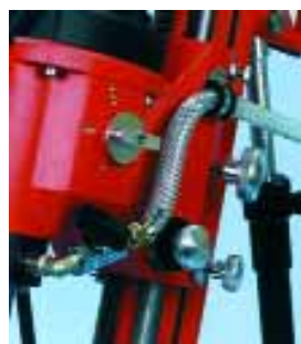
Cuplare directă a furtunului de alimentare cu apă
