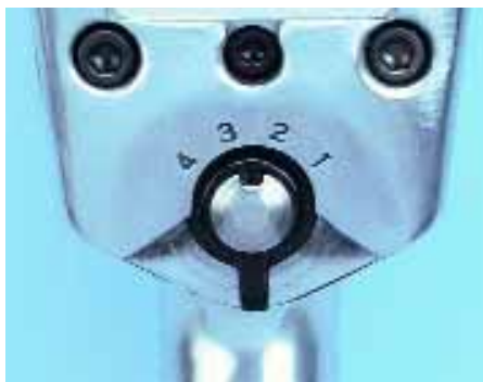
4 trepte de reglare a momentului de pornire
