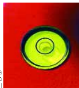
Nivelă cu bulă pentru ajustarea poziției suportului
